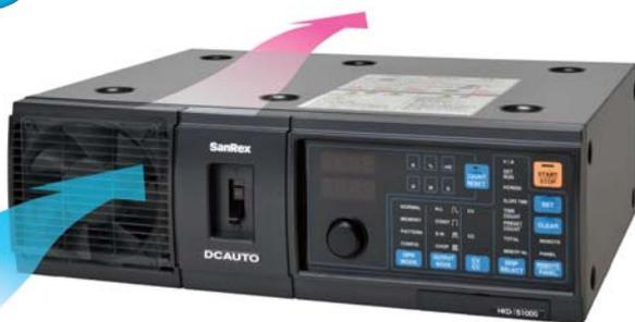
内部がダクト構造で、ヒートシンクのみを風で冷却しています。電子部品部は周囲環境からの影響を少なくし、長期に安定した特性を維持します。
